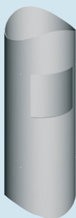
Rauchrohr mit Öffnung
